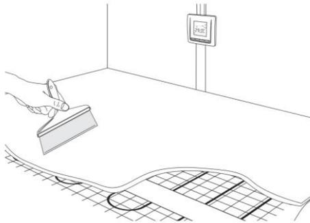
10. После полного высыхания плиточного клея еще раз с помощью омметра замерить сопротивление нагревательной секции и с помощью мегаомметра измерить сопротивление изоляции нагревательной секции. Измеренные данные внести в гарантийный сертификат.
