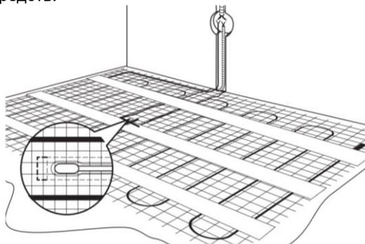
8. Вывести монтажный конец двухжильного нагревательного мата к месту расположения терморегулятора через канавки, подготовленные в стене. Визуально проверить отсутствие обрывов (с помощью омметра замерить сопротивление нагревательной секции и с помощью мегаомметра измерить сопротивление изоляции нагревательной секции).
