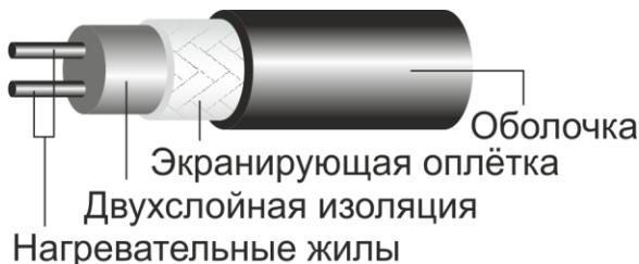
Рисунок 3 - Устройство нагревательного провода.
