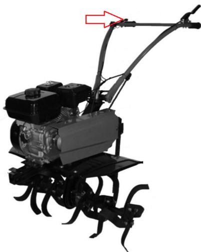
Переведите выключатель зажигания двигателя в положение «ВКЛ».
