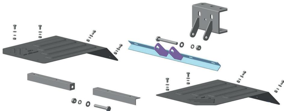
Установите заднюю соединительную планку и закрепите с помощью болта M10x90, шайбы M10, гровера M10, гайки M10. Не затягивайте гайку, только наживите.
