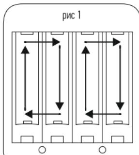
Когда Вы устанавливаете аккумуляторы, электрическая цепь должна быть замкнута, поэтому следует заряжать 2 или 4 аккумулятора одного типа и системы одновременно. При зарядке только 2 аккумуляторов АА или ААА поместите их вместе с левой или правой стороны.
