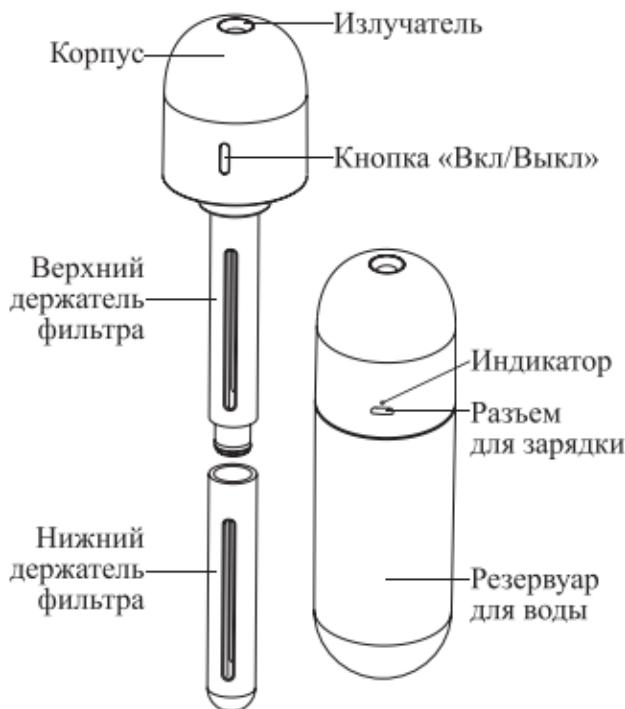
Нажмите на **кнопку «Вкл/Выкл»** один раз для включения прибора. По умолчанию увлажнитель включит непрерывную подачу тумана. Нажмите на кнопку «Вкл/Выкл» второй раз, чтобы включить импульсную подачу тумана. Туман будет подаваться в течение 3 секунд с перерывами 2 секунды. Нажмите на кнопку «Вкл/Выкл» третий раз, чтобы выключить прибор.
