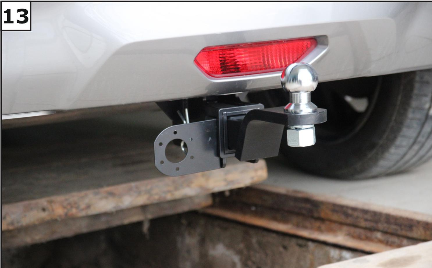
Установить подрозетник (6), закрепив с помощью болта М8 (21), шайбы 8 (24), шайбы 8 пружинной (23), шайбы 8 увел (25) и гайки М8 (22). Установить переходник (7), закрепив с помощью штифта (9) и шплинта (10).
