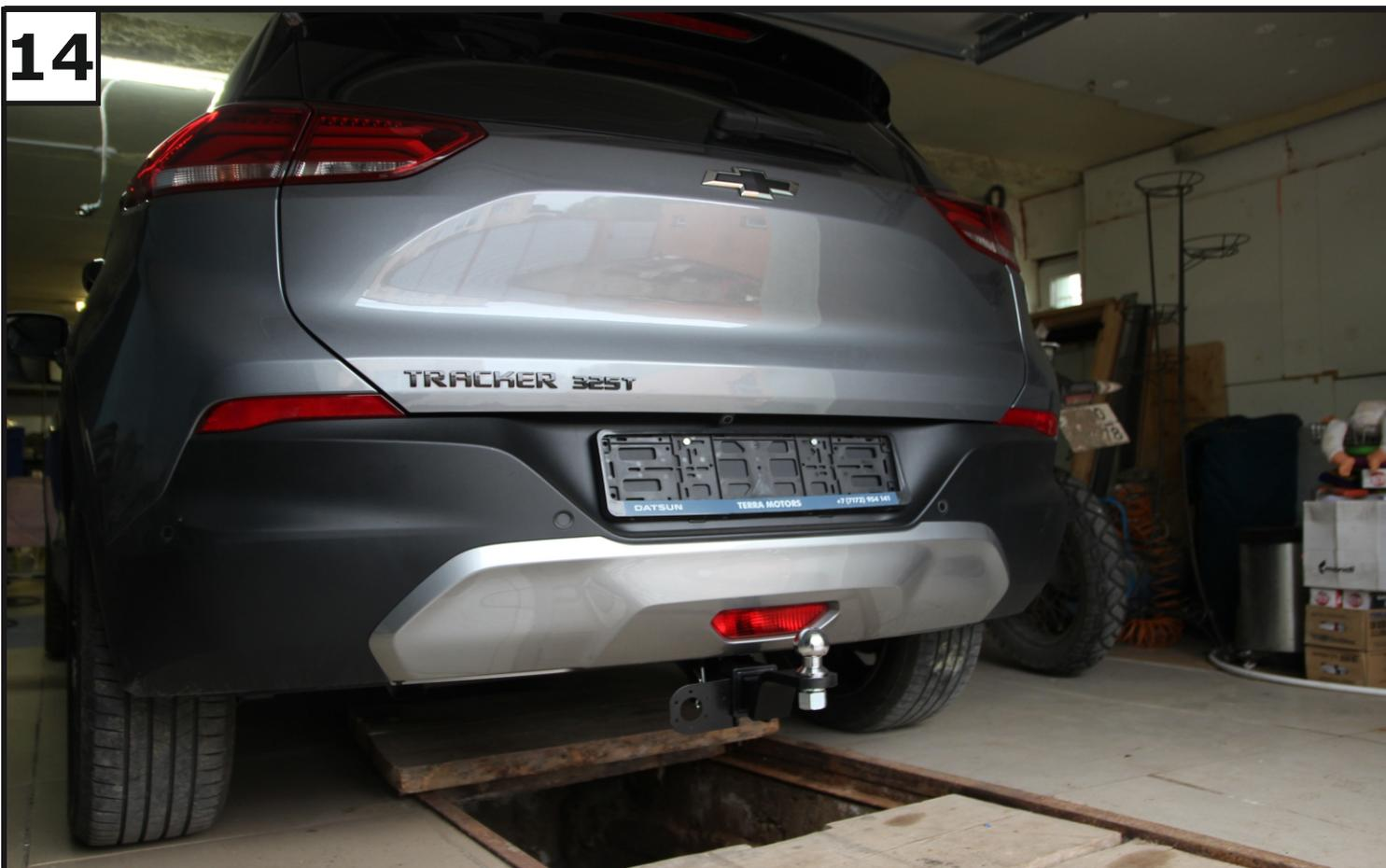
Зафиксировать переходник болтом М10х20 (11)-фиксацию использовать только без нагрузки. Установить на переходник шар (8), закрепив гайкой М24 (20) с шайбой 24 пружинной (19). Затянуть все резьбовые соединения. Моменты затяжек: М8=25Нм, М10=47Нм, М24=95Нм.
