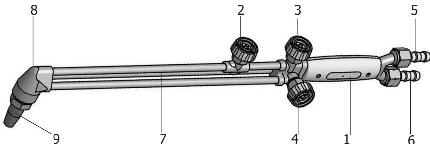
Расположение смесительного узла в мундштуке существенно повышает безопасность резака при возникновении внутреннего горения (обратного удара). Трубы, изготовленные из нержавеющей стали. Конструкция резака позволяет производить замену газосмесительных мундштуков непосредственно на рабочем месте.
