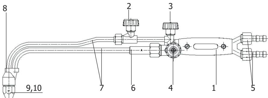
При движении кислорода через инжекторное устройство создается разжение в смесительной камере, обеспечивающее подачу и смешивание горючего газа с кислородом. Регулирование расхода кислорода и газа осуществляется соответствующими вентилями.
