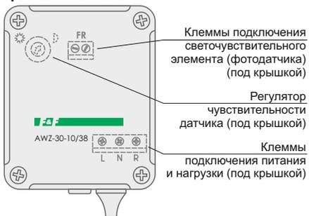
Клеммы подключения светочувствительного элемента (фотодатчика) (под крышкой)
