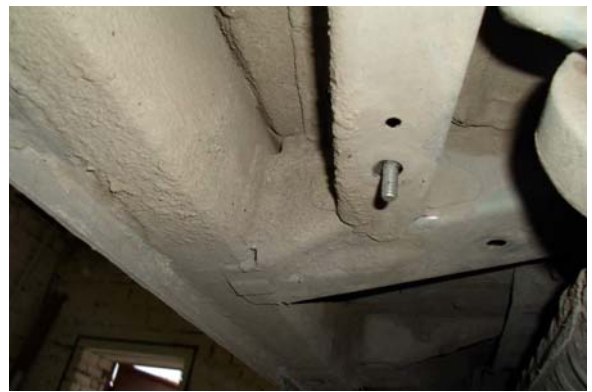
Рис.5 Место крепления среднего кронштейна
