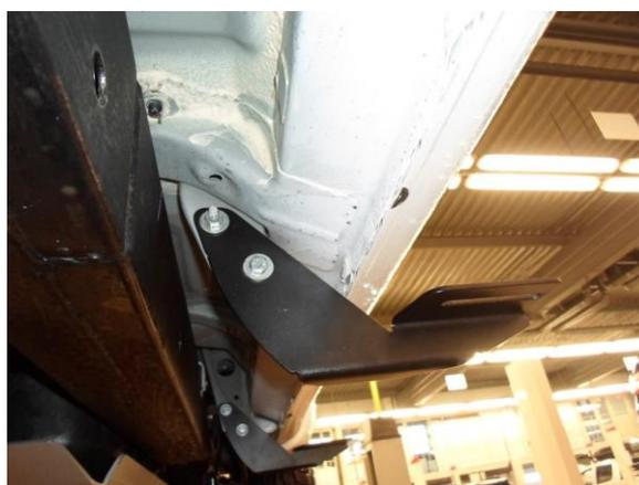
Рис.3 Установка кронштейна в средней части порога автомобиля.
