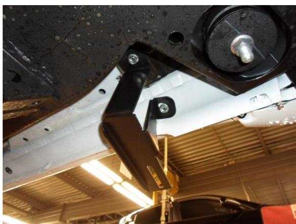
Рис.2 Установка кронштейна в передней части порога автомобиля.
