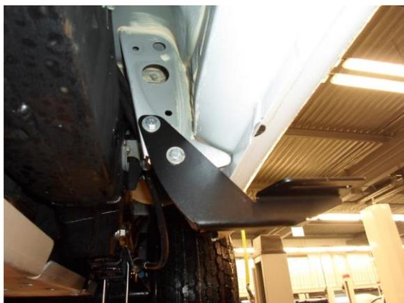
Рис.4 Установка кронштейна в задней части порога автомобиля.
