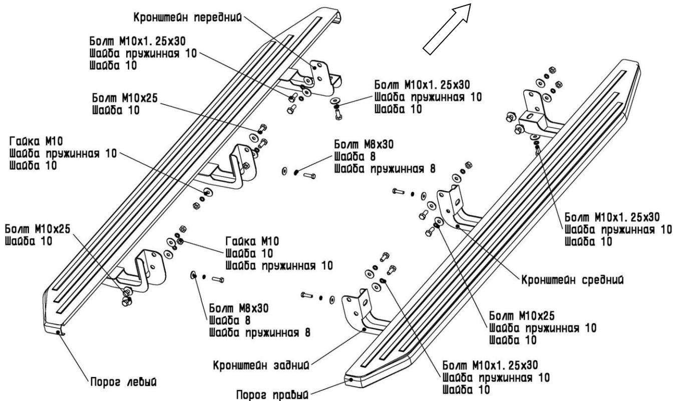
Рис. 1 Схема установки комплекта порогов
