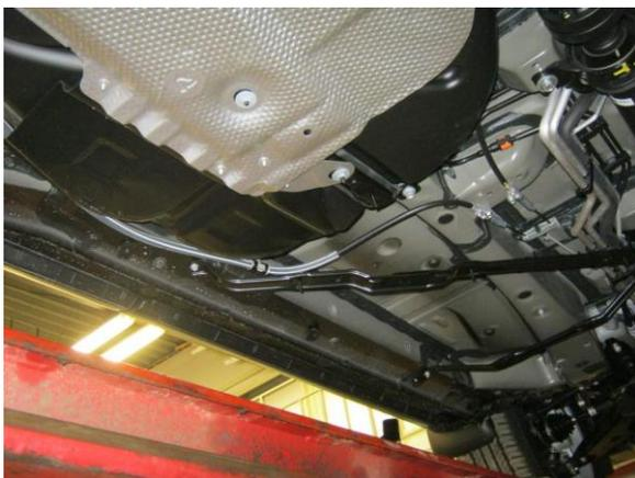
Рис.2 Днище автомобиля со снятыми пыльниками
