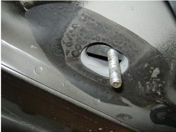
Рис.6 Установка шпильки закладной
