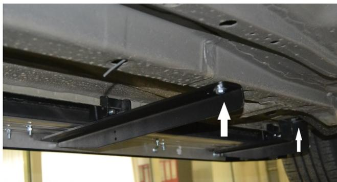
Рис. 2б - Установка средних и задних кронштейнов
