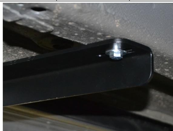
Рис. 2а - Установка передних кронштейнов
