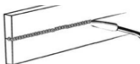
Рисунок 22. Сварка в горизонтальном положении
