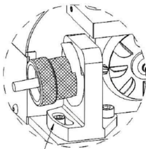
Угол при вершине можно регулировать от  $95^\circ$  до  $135^\circ$
