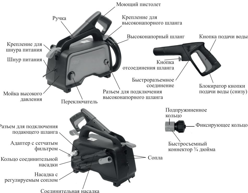
Принцип работы мойки высокого давления прост. Вода из источника водоснабжения подкачивается в насос, где давление повышается до необходимой степени, а затем подается в моющий пистолет. Мощная струя воды разрушает загрязнения посредством механического воздействия и одновременно смывает их с очищаемой поверхности.
