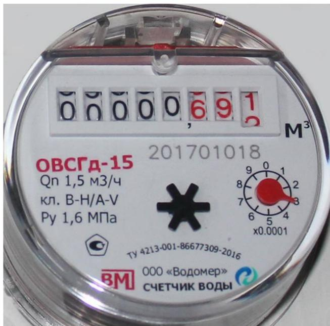
Рисунок 1. Измерительный индикатор счётчика ОВСГ-15
