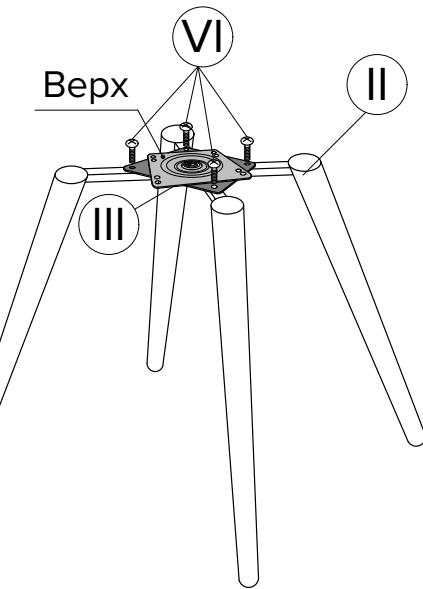
Для удобства монтажа необходимо повернуть верхнюю часть поворотного механизма относительно нижней на 45°
