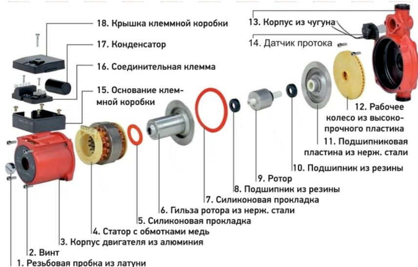
В основе насосов для повышения давления PROFLINE – циркуляционный насос с мокрым ротором. Он может работать в одном из выбранных режимов – ручном или автоматическом. Имеет чугунный корпус и антикоррозийное катафорезное покрытие. Класс электрозащиты составляет IP42, что предотвращает попадание брызг внутрь корпуса. Уровень шума во время работы составляет всего 35 дБ, что дает возможность устанавливать насос в квартире.
