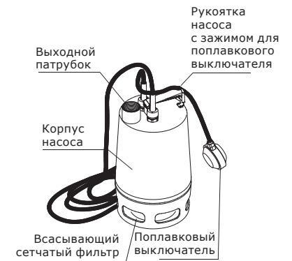
Рис. 1 Конструкция насосов APV.06 / APV.40 V
