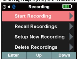
2. В меню **Recording** нажмите программную кнопку **Up/Down**, чтобы выбрать **Setup New Recording** (Настройка новой записи), а затем программную кнопку **Enter** для перехода в настройки продолжительности и времени выборки. См. рисунки ниже.
