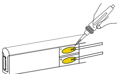
1. Пайка ленты гибкой печатной платы осуществляется легкоплавкими припоями на основе сплава олова и свинца серии ПОС с температурой плавления в диапазоне 183 – 300 градусов Цельсия.
