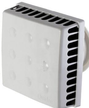
Патрубок клапана с силиконовым уплотнителем продевается через квадратную уплотнительную прокладку, плотно вводится в трубу и фиксируется к стене с помощью 4-х шурупов. Узел регулировки позволяет регулировать степень открытия/закрытия заслонки при помощи утопленного колесика на корпусе или шнура.
