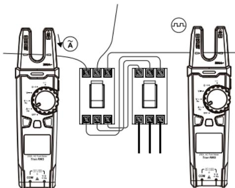
Рис. 3 Измерение переменного тока и частоты
