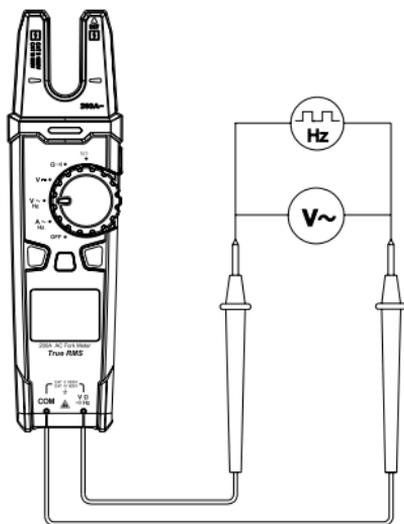
Рис 5. Измерение напряжения переменного тока и частоты
