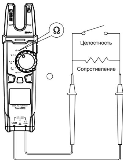
Рис 6. Проверка целостности цепи и измерение сопротивления
