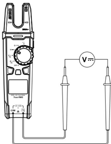
Рис 4. Измерение напряжения постоянного тока
