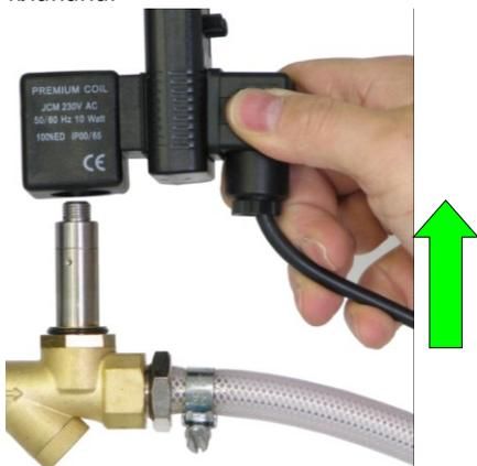
6. Открутите вал клапана с помощью ключа по 23 миллиметра.
