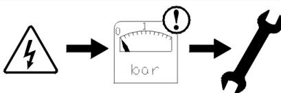
2. Перед установкой или обслуживанием устройства сбросьте давление в системе!
