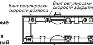
Регулировка производится двумя винтами, которые расположены на торце корпуса доводчика:
