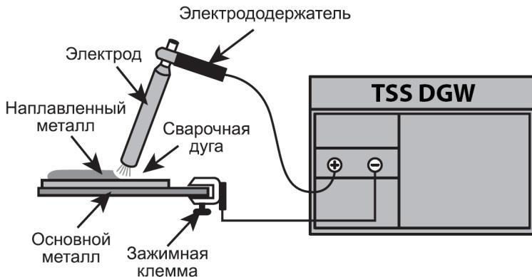
*Рис. 10 Схема подключения сварочного генератора.
