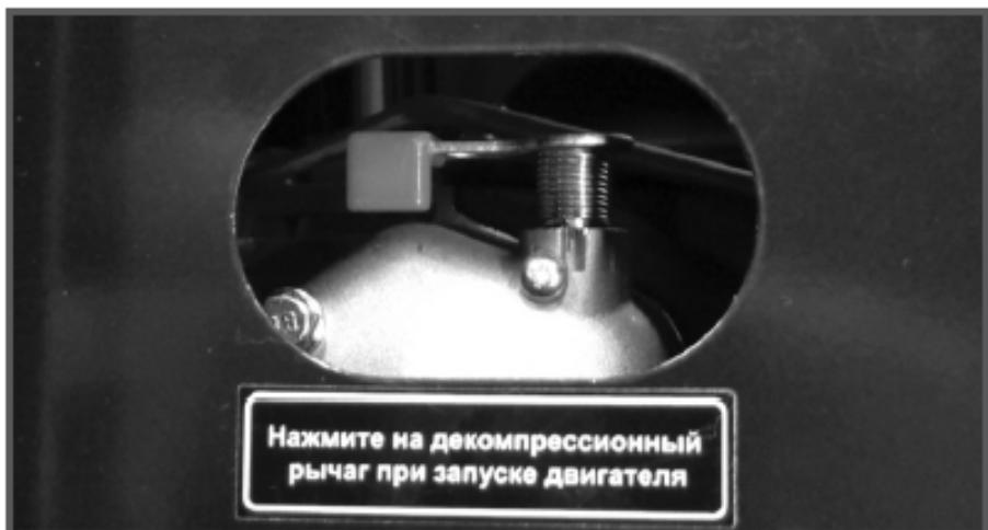
Рис. 6 Рычаг декомпрессора
