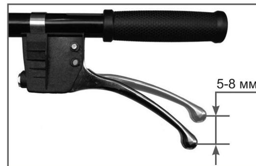
После окончания регулировки закрутите контргайку.
