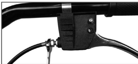
Натяжение троса газа регулируется регулировочной муфтой. При закручивании или выкручивании регулировочной муфты из кронштейна рычага газа происходит ослабление или натяжение троса газа соответственно. Свободный ход рычага газа должен быть 5 – 8 мм.
