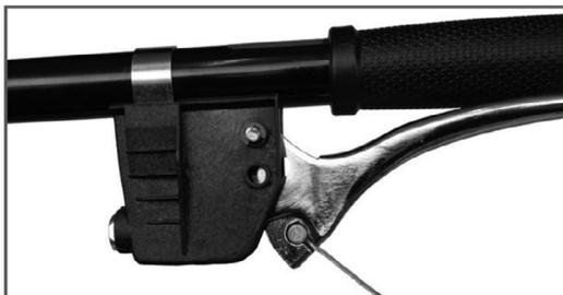
Протяните трос газа через проточку в рычаге и кронштейне рычага газа и закрутите регулировочную муфту троса газа в кронштейн рычага газа.
