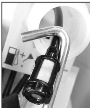
Для проверки или замены топливного фильтра выполните следующие действия.
