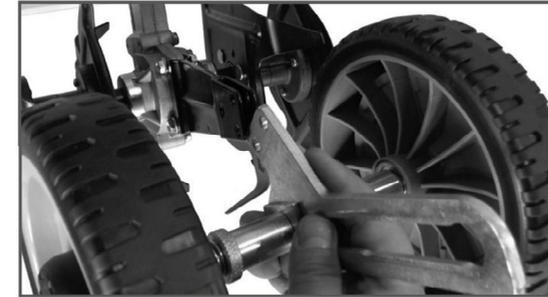
Установите сошник в кронштейн сошника и зафиксируйте его штифтом (рис. А). Зафиксируйте штифт шплинтом (рис. В).
