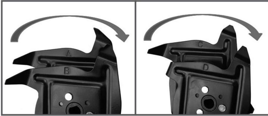
Между каждой парой фрез нужно установить шайбу из войлочной шерсти. После установки фрез на ведомый вал редуктора необходимо обязательно зафиксировать фрезы шплинтами. Установка фрез показана на рисунке ниже, где 1 – шплинт (2 шт.), 2 – шайба из войлочной шерсти (2 шт.), А, В, С, D – фрезы.
