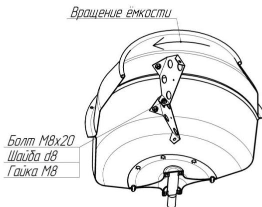
Рис.2. Ёмкость со сборной лопастью в разрезе
