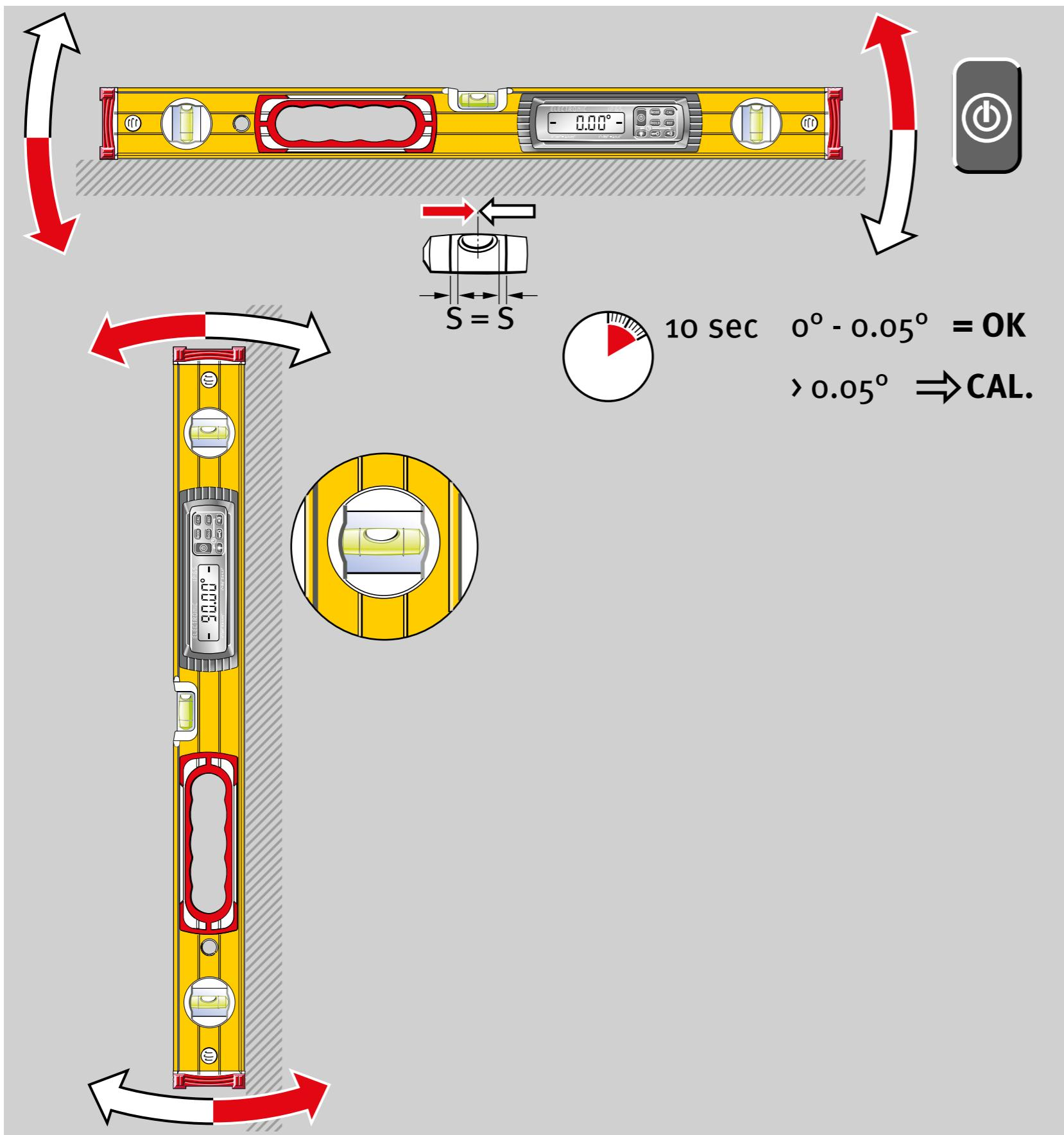
В случае использования преимущественно в вертикальной плоскости проверка точности также возможна с помощью вертикальной пузырьковой камеры.
