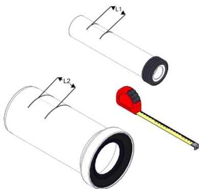
5. Обрезать соединительные патрубки (п. 9, поз. 23) по размерам.
