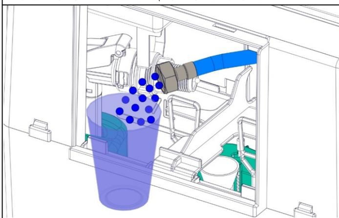
4. Прикрутить гибкую подводку (не входит в комплектацию), усилие затяжки не более 4 Н·м.
