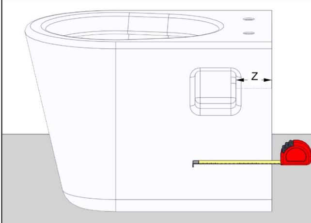
7. Обрезать шпильки кронштейна (п. 9, поз. 8) по размерам.
