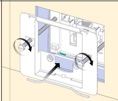
3. Закрутить винты установочные зеленые (п. 9, поз. 4), обеспечить вылет 25 мм.
