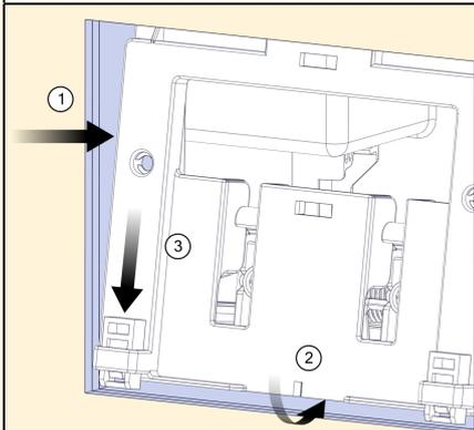
2. Установить рамку панели кнопок (п. 9, поз. 3), закрутить винты установочные белые (п. 9, поз. 2).
