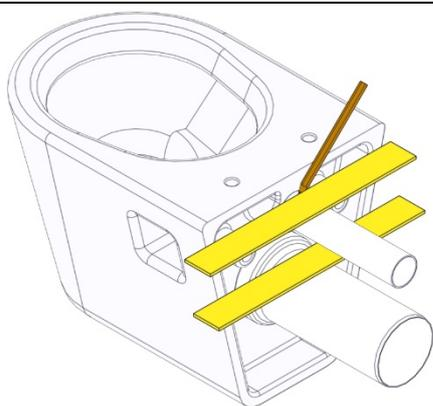
3. Вставить соединительные патрубки (п. 9, поз. 23) в инсталляцию, разметить нужную длину.
