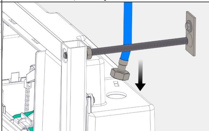
3. Слить воду во избежание засорения рабочих механизмов инсталляционной системы.
