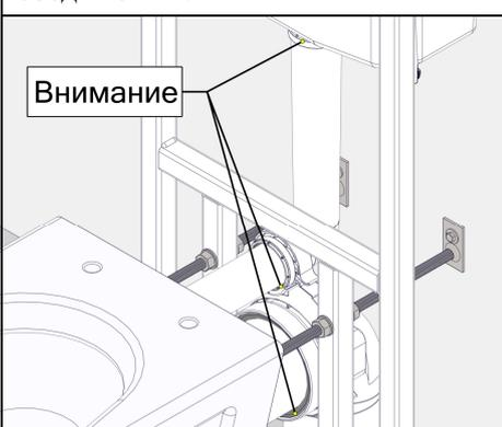
5. Проверить герметичность соединений.
