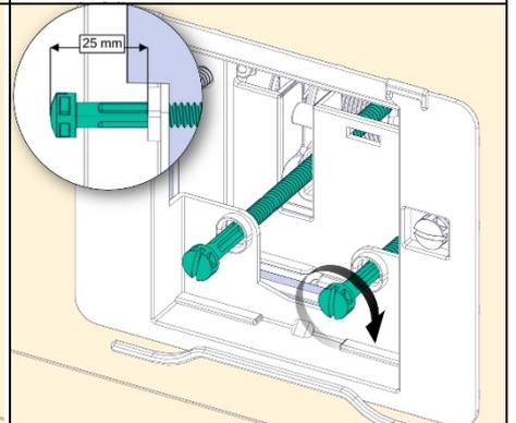
4. Установить панель кнопок (п. 9, поз. 5).
