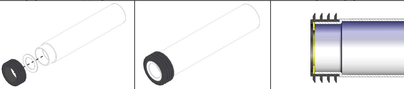
2. Вставить соединительные патрубки (п. 9, поз. 23) в унитаз, разметить нужную длину.
