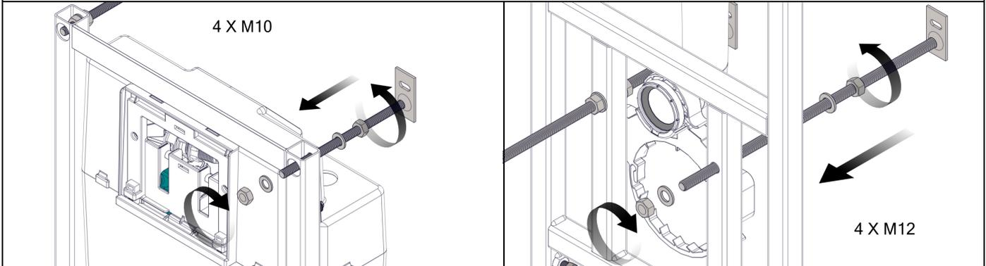
2. Установить раму по уровню и размерам (см. п. 8), регулировать с помощью гаек с внешней стороны, выставить раму, затянуть гайки с внутренней стороны (п. 9, поз. 18, 7), затянуть винты установочные (п. 9, поз. 13), усилие затяжки не более 10 Н·м, разметить отверстия.
