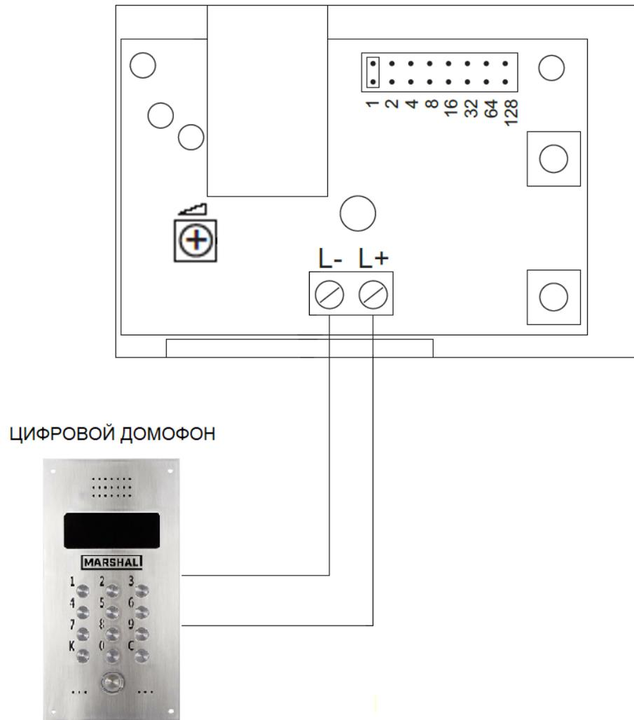
Для цифрового домофона в трубке необходимо установить адрес квартиры на блоке переключателей (см. «Обозначения и назначение частей аудио трубки»). Доступный диапазон установки адресов от 1 до 255. Пример установки адреса квартиры №86 с помощью переключателей:
