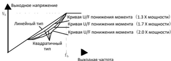
▲ **Примечание:** На рисунке,  $V_b$  – номинальное напряжение двигателя, а  $f_b$  – номинальная частота двигателя.
