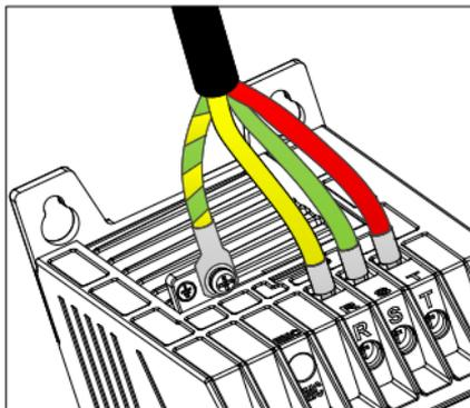
2. Подсоедините желто-зеленый провод заземления кабеля двигателя к клемме PE преобразователя частоты, подсоедините 3Ф кабель двигателя к клеммам U, V, W и затяните..
