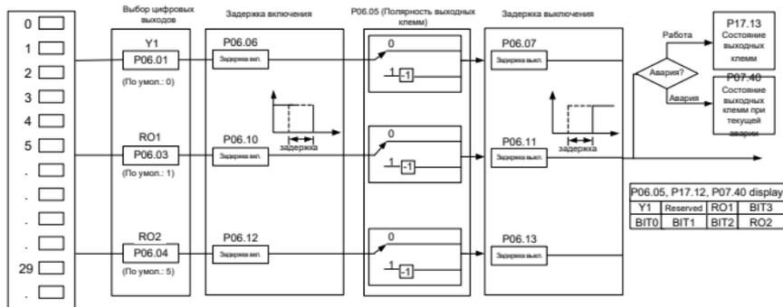
В следующей таблице перечислены значения функциональных параметров P06.01–P06.04. Одна и та же функция для выходной клеммы может быть выбрана повторно.
