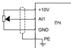
Рисунок 4-14 Подключение экрана к клемме PE
