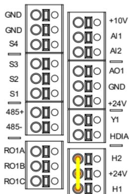
Рисунок E-2 Схема подключения функции STO
