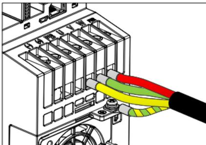
3. Подсоедините дополнительное оборудование, такое как тормозной резистор, к которому подведены кабели, в указанные места. См. раздел 4.4.1 Подключение к главной цепи.
