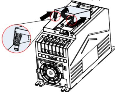
**Шаг 2** Поднимите крышку и вытяните ее немного наклонив.
