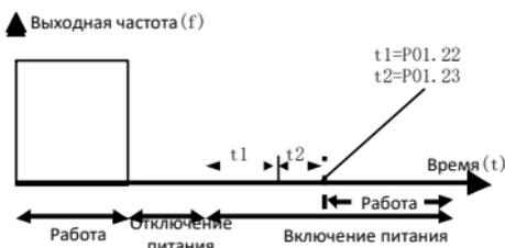
На следующем рисунке показана логическая схема перезапуска после выключения питания:
