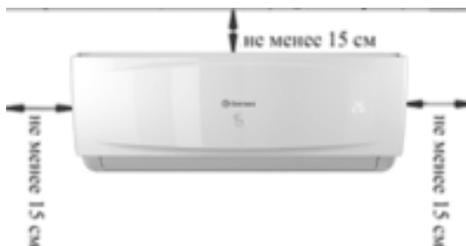
Рис.4 Определение места для установки внутреннего блока.
