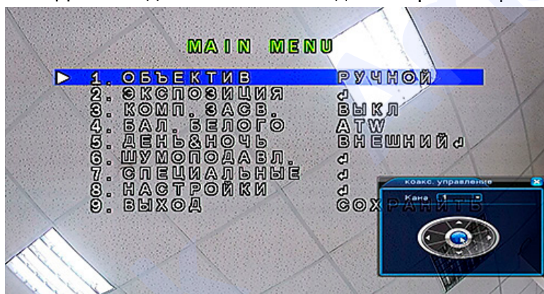
Рис. 3.16 Управление по коаксиалу
