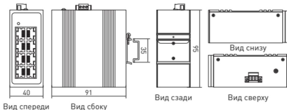
Рис. 1 — Габаритные размеры TSX-U-8T
