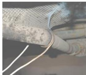
Гибкий индуктор используется для разогрева арматуры мостов, усиленных датчиков, шаровых шарниров, выпускной системы авто и т.д. и в случаях, где не представляется возможным использовать стандартные индуктора.
