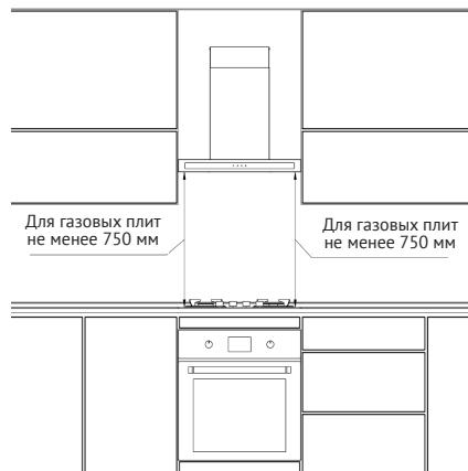
При наличии в комнате печи, газового котла или колонки необходимо учитывать, что во время работы вытяжка забирает из помещения воздух, необходимый для горения. Это относится также к помещению с герметичными окнами и дверями.
