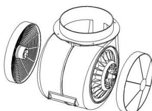
Угольные фильтры, предназначенные для использования вытяжки в режиме рециркуляции воздуха и могут применяться в зависимости от серии и типа вытяжки. Угольные фильтры необходимо менять на новые через 3-6 месяцев использования, в зависимости от частоты приготовления пищи.
