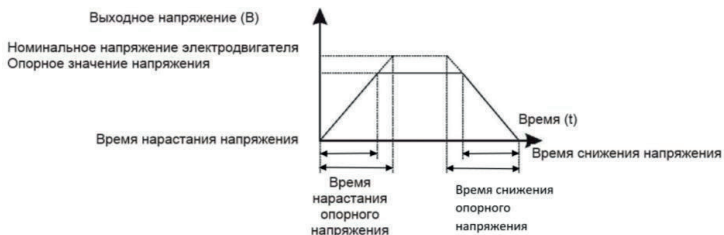
Рис.6.8 Время нарастания и снижения напряжения
