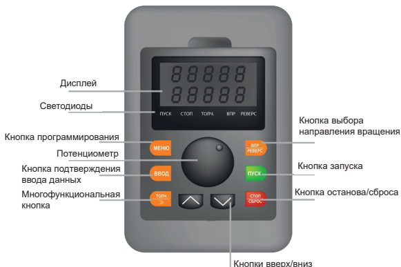
Рис. 5.1 Функции кнопок и светодиодов панели управления LCI
