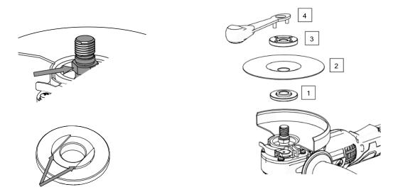
2. Установите абразивный круг на внутренний фланец и выровняйте отверстие.
