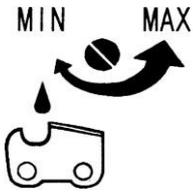
(e). Регулировка масляного насоса:
