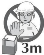
6. Всегда аккуратно заливаете топливо. Вытрите пролитое топливо, затем отойдите на расстояние не менее 3 метров от места разлива топлива, прежде чем запускать двигатель.
