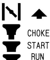
(d). Управление рычагом всасывания: потяните рычаг всасывания, чтобы закрыть всасывание; нажмите рычаг всасывания, чтобы открыть всасывание.
