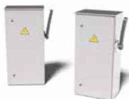
Ящики силовые ЯРП предназначены для нечастых (не более 3-х в час) включений и отключений силовых электрических цепей напряжением 380/220 В переменного тока частотой 50 Гц с системами заземления, а также для их защиты при перегрузках и коротких замыканиях.
