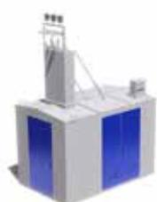
Киосковые трансформаторные подстанции (КТПК) тупикового и проходного типа мощностью до 630 кВА, напряжением 6 (10) кВ, напряжением НН 0,4 кВ, представляют собой однострансформаторные подстанции, предназначенные для приема, преобразования и передачи электрической энергии трехфазного переменного тока.
