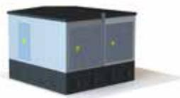
Блочные комплектные трансформаторные подстанции (БТП) тупикового и проходного типа мощностью от 100 до 2500 кВА, корпус которых выполняется из теплоизолирующих сэндвич - панелей или железобетона. Комплекуются распределительными устройствами собственного производства (КРУ, КСО, ГРЩ)
