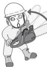
19. Защитите себя от отдачи. Если шина и цепь застрянут в заготовке, существует высокий риск внезапного отскока шины вверх и обратно в сторону пользователя (отдача). Отдача также может возникнуть, если вы врезаетесь в заготовку кончиком шины, поэтому всегда режьте нижней ее частью. В этом случае отдача направлена в сторону от пользователя. Отдача может привести к потере управления.
