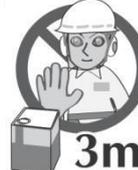
6. Обращайтесь с топливом осторожно. Перед включением пилы вытрите пролитое топливо и удалитесь от места заправки на расстояние не менее 3 м.
