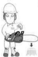
Крайне важно проверять исправность тормоза цепи перед каждым использованием и остроту цепи для поддержания уровня безопасности отдачи данной пилы. Снятие защитных устройств, ненадлежащее обслуживание или неправильная замена шины или цепи могут увеличить риск получения серьезных травм из-за отдачи.
