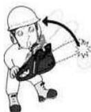
19. Предохраняйтесь от отдачи. Отдача - это движение направляющей шины вверх, которое возникает, когда пильная цепь в носовой части направляющей шины соприкасается с каким-либо предметом.
