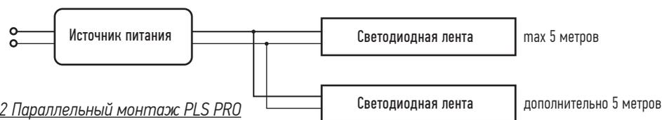
Рис.2 Параллельный монтаж PLS PRO
