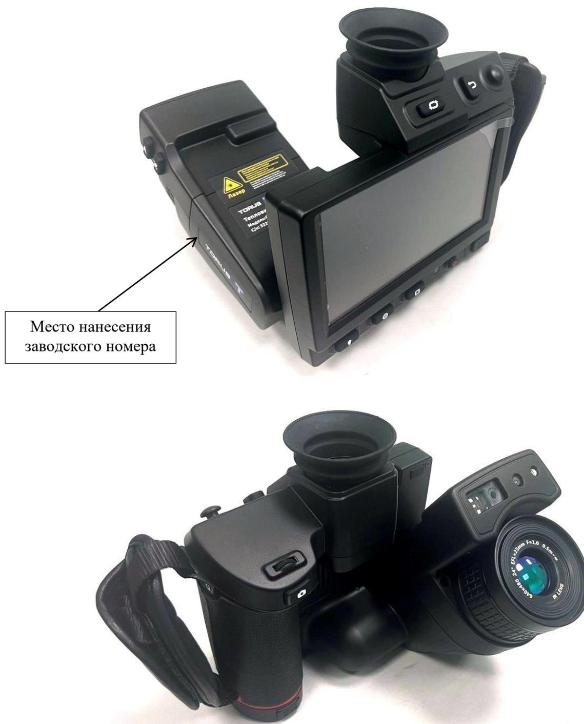
Рисунок 1 - Общий вид камер тепловизионных TORUS
