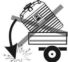
Нельзя сбрасывать или ронять ёмкость при разгрузочно-погрузочных работах.
