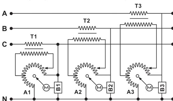
N - нейтральный проводник, A B C - трёхфазный ввод, M - сервоприводы, A1 A2 A3 - автотрансформаторы, B1 B2 B3 - платы управления, T1 T2 T3 - вольтодобавочные трансформаторы
