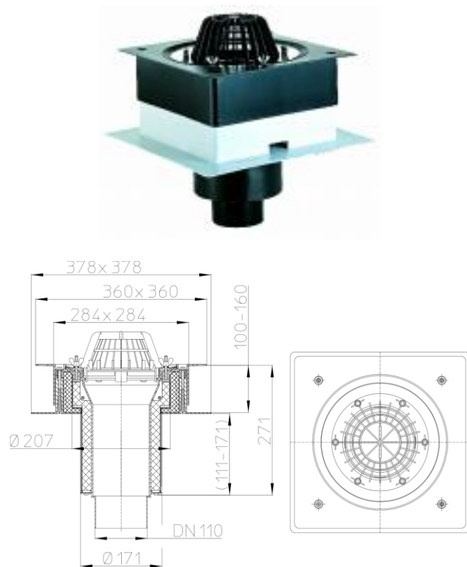
Рис. 2. Кровельная воронка HL63/1.
